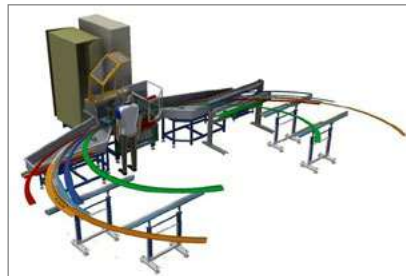
Machine UTPA (256 voies) 100% automatique de contrôle de profilés composites
